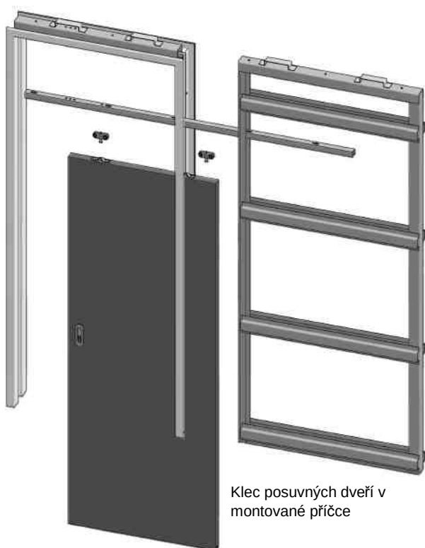
Zárubeň pro posuvné dveře v montované příčce (Obrázek provedení pravé)
