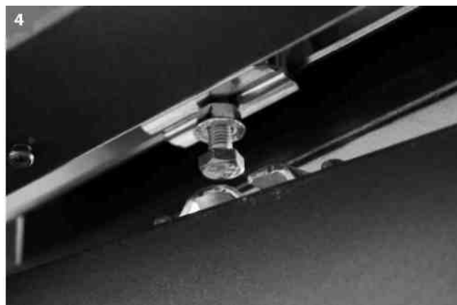
Dveřní křídlo nasuňte vybráním upínacího plechu na dřík šroubů vodících kladek. Výškové umístění dveří nastavte před nasazením křídla zašroubováním nebo vyšroubováním šroubů vodících kladek.
