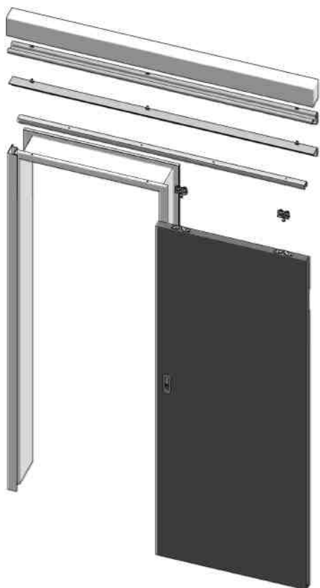
Zárubeň pro posuvné dveře před zdí (Provedení pravé)
