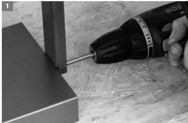
1 Transportní vzpěra musí být před montáží odstraněna
