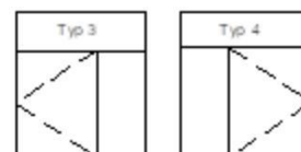
Zárubeň LZ s postranním světlíkem pro jednostranné zasklení
